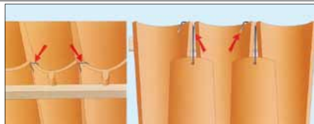
Dettaglio di intradasso ed estradasso di coppi con dente e con foro fissati tra loro con apposito gancio
