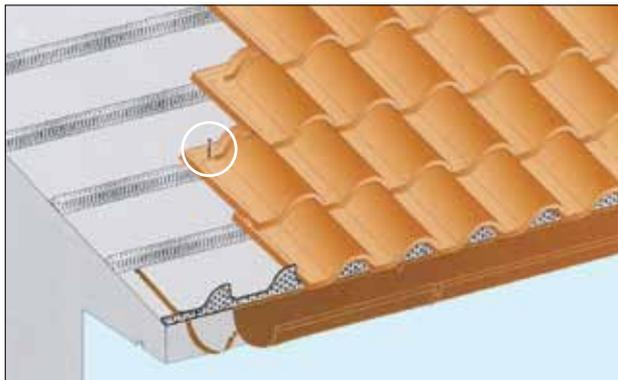
Esempio di fissaggio di un manto di tegole mediante viti
