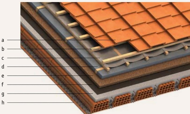
Legenda: *a* manto in laterizio, *b* intercapedine ventilata 6 - 8 cm, *c* membrana impermeabile traspirante "a corda blanda" S<sub>d</sub>, *d* isolante: polistirene espanso (EPS), *e* isolante: fibra di legno mineralizzata (FLM), *f* elemento di tenuta all'aria e/o all'acqua (eventuale), *g* solai in latero-cemento 20 + 6 cm, *h* intonaco
