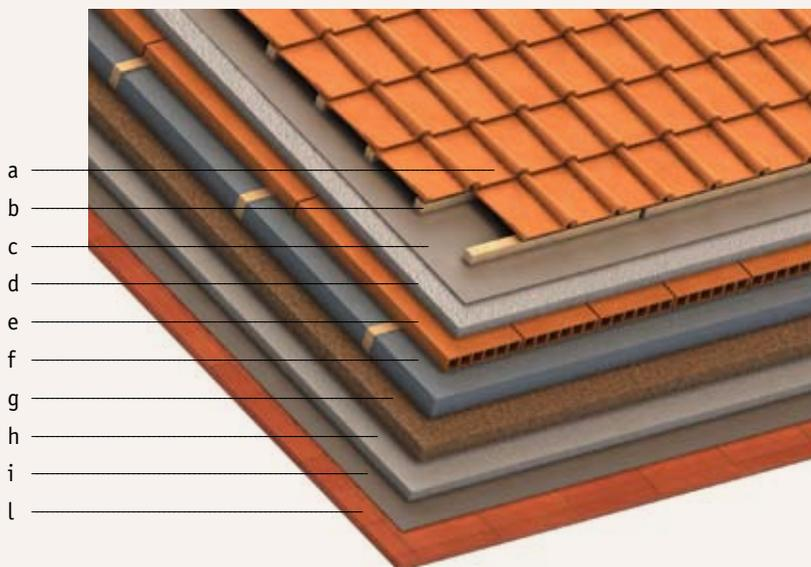
Legenda: *a* manto in laterizio, *b* intercapedine ventilata 3 - 4 cm, *c* telo impermeabile traspirante Sd<sub>v</sub>, *d* massetto alleggerito per il fissaggio dei listelli 3-4 cm, *e* tavelloni con fori perpendicolari alla linea di gronda, *f* isolante: polistirene espanso (EPS), *g* isolante: fibra di legno mineralizzata (FLM), *h* massetto collaborante in cls, *i* telo polietilene, *l* tavelle in laterizio 3,3 cm
