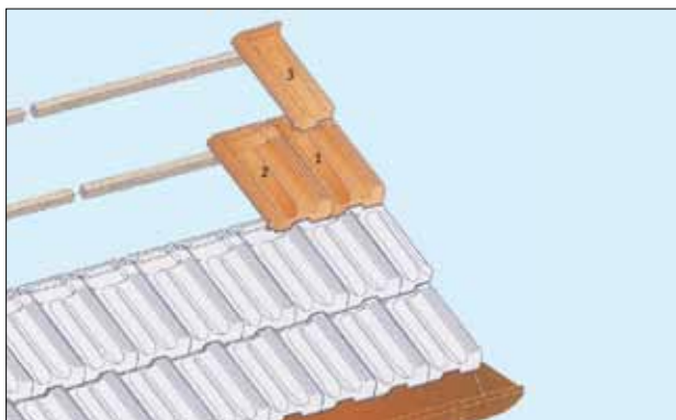
Sequenza di messa in opera di un manto di copertura in tegole marsigliesi
