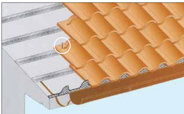
Esempio di fissaggio di un manto di tegole mediante viti autofilettanti
