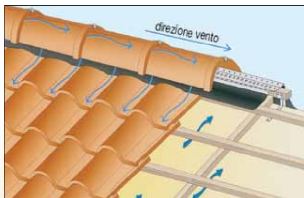
Linea di colmo: dispositivo per l'uscita dell'aria dalla camera di microventilazione
