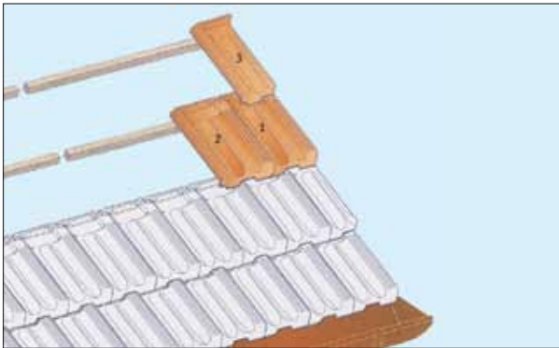
Sequenza di messa in opera di un manto di copertura in tegole marsigliesi
