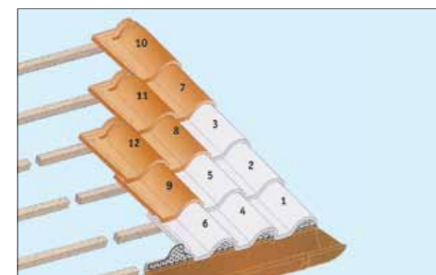
Sequenza di messa in opera di un manto di copertura in tegole portoghesi
