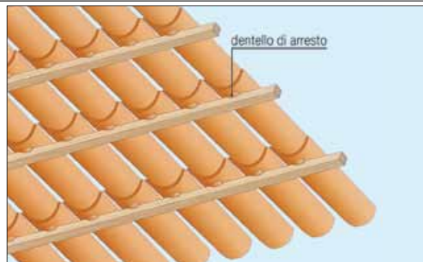
La messa in opera di coppi muniti di apposito dentello di aggancio o applicati con chiodatura può avvenire anche su una singola listellatura (alla lombarda)
