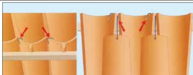
Dettaglio di intradosso ed estradosso di coppi con dente e con foro fissati tra loro con apposito gancio
